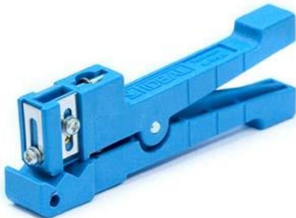
Есть и другие инструменты для этой операции. Надевая стриппер-прищепку на модуль в месте отметки, делаем 1-2 оборота по часовой стрелке. По правилам срезать модуль нужно частями, приблизительно по 30-40 см и это будет правильно. Волокна освобождены от модулей, протерты и сияют чистотой.
