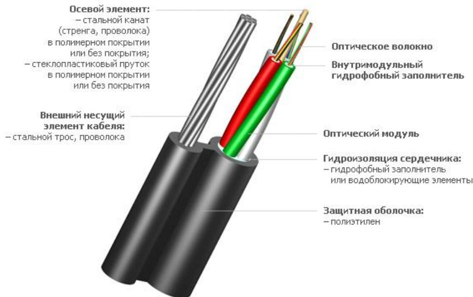
Подвесной оптический кабель с внешним металлическим силовым элементом на основе модульной конструкции. Оптические кабели марки ИК/Т предназначены для подвески на опорах линий связи, между зданиями и сооружениями.
