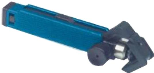
С помощью этого стриппера делаем поперечные надрезы на кабеле через равные промежутки (предварительно откусив силовой элемент специальными тросокусами).
