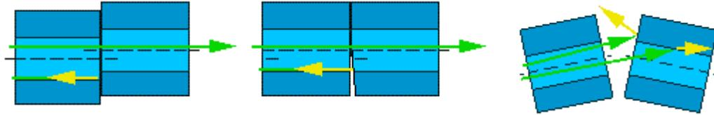
Неидеальная геометрическая форма волокон также вносит вклад в потери мощности. Это может быть и эллиптичность световода и нецентричность его сердцевины. Торцы самого световода могут содержать деформации: сколы и шероховатости, что в свою очередь уменьшает рабочую поверхность соприкосновения волокон.
