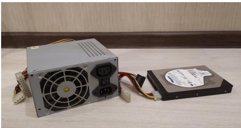
3. Вставляем кабель питания в БП. Другой конец кабеля – в розетку. Кнопку включения на самом блоке пока не нажимаем.
