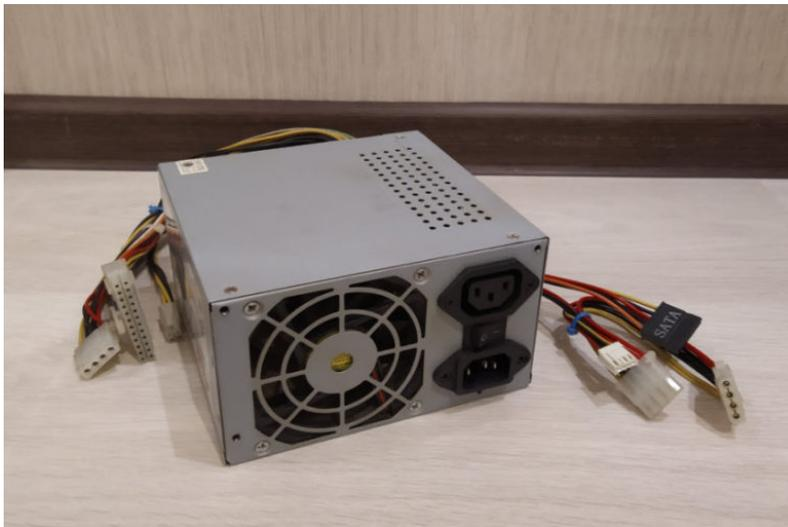
2. Берем ненужный старый жесткий диск и подключаем его к разъему **Molex**. Этот пункт делать не обязательно, но желательно – просто некоторые БП могут не включиться, если нет никакой нагрузки. Так вот, в нашем случае жесткий диск и служит этой нагрузкой. Вместо жесткого можно подключить, например, вентилятор с molex-интерфейсом.
