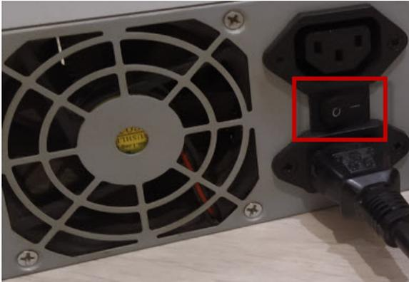
На исправном блоке тут же начнет крутиться вентилятор и он включится. Если же ничего не происходит – значит БП неисправен (при условии, что кабель питания точно рабочий).
