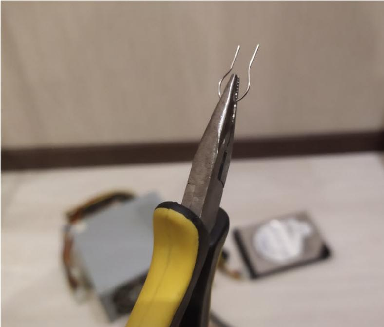
5. На главном разъеме БП (тот, который втыкается в материнскую плату) находим **зеленый** провод. С помощью нашей перемычки замыкаем **зеленый** провод с любым **черным** проводом:
