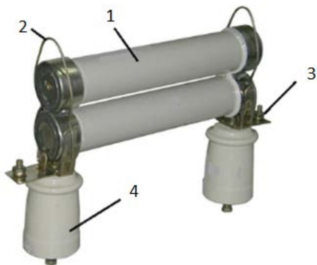
Рисунок 13 - Внешний вид высоковольтного предохранителя типа «ПКТ 103-6»: 1 - предохранитель, 2 - контакт с замком, 3 - хвостовик контакта, 4 - опорный изолятор.
