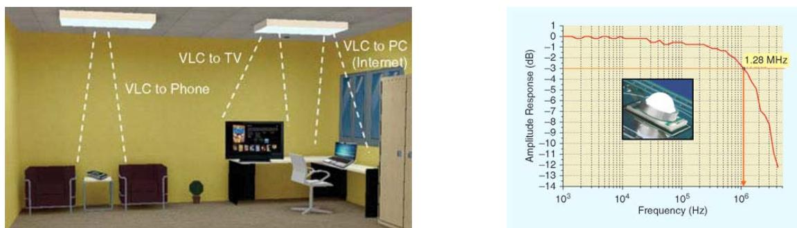
Рис. 12 Концепция Li-Fi (слева) и частотная характеристика современного люминофорного светодиода (Cree, XLamp XR-E LED)
