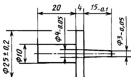
Рисунок 4 — Испытательный стержень
