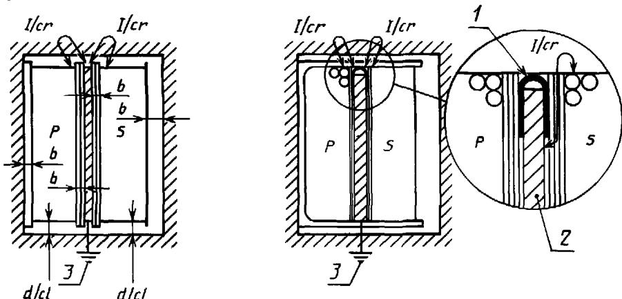
1 — клейкая связующая лента; 2 — экран; 3 — заземление
