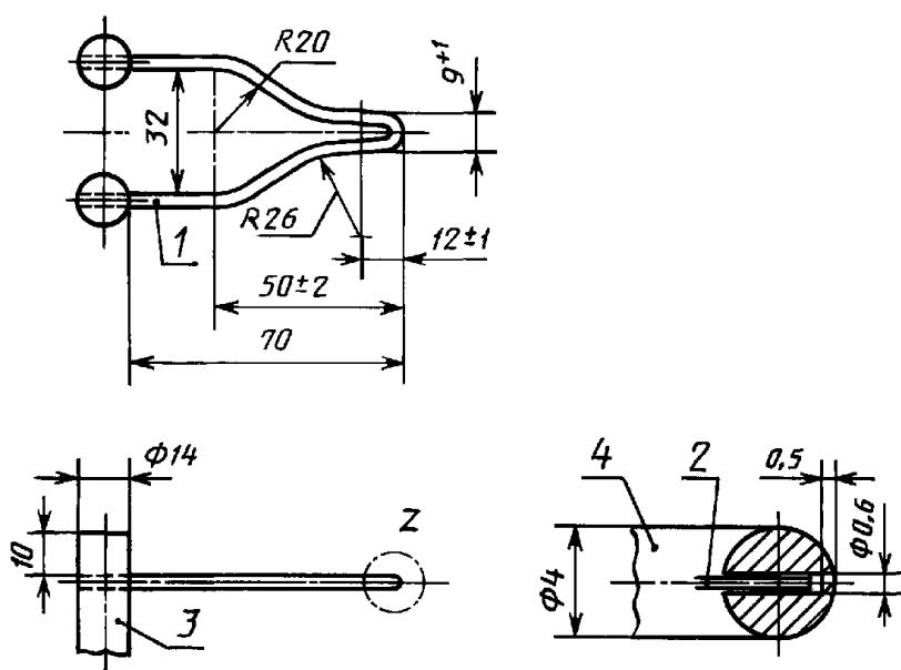
1 — проволока накала, припаянная на стержень; 2 — термопара;
