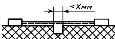
Условие: рассматриваемый путь включает паз с параллельными или сходящимися боковыми стенками любой глубины и шириной меньше  $X$  мм.
