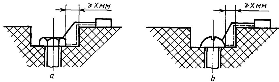
Зазор между головкой винта и стенкой выемки достаточно широк и его следует учитывать.
