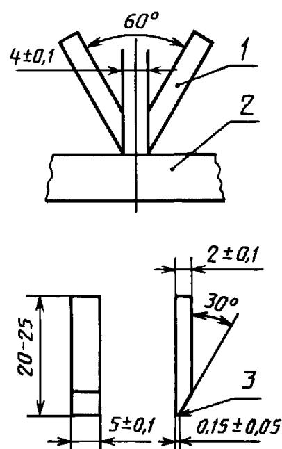
1 — электрод; 2 — образец; 3 — слегка закругленный край
