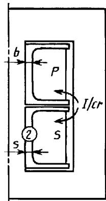
1 — трубка толщиной, указанной для дополнительной изоляции, или не менее трех слоев ленты (см. раздел 25); 2 — формованная часть толщиной, указанной для дополнительной изоляции (см. раздел 25); 3 — изоляционная вставка (прокладка); 4 — дистанционная прокладка (например четыре прокладки)
