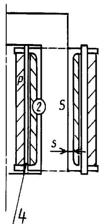
**I.2 Каркасы для обмоток, расположенных рядом**
