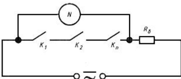
$N$  - индикатор;  $R_6$  - балластный резистор;  $K_1, K_2, \dots, K_n$  - контакты выключателя проверяемых резисторов
